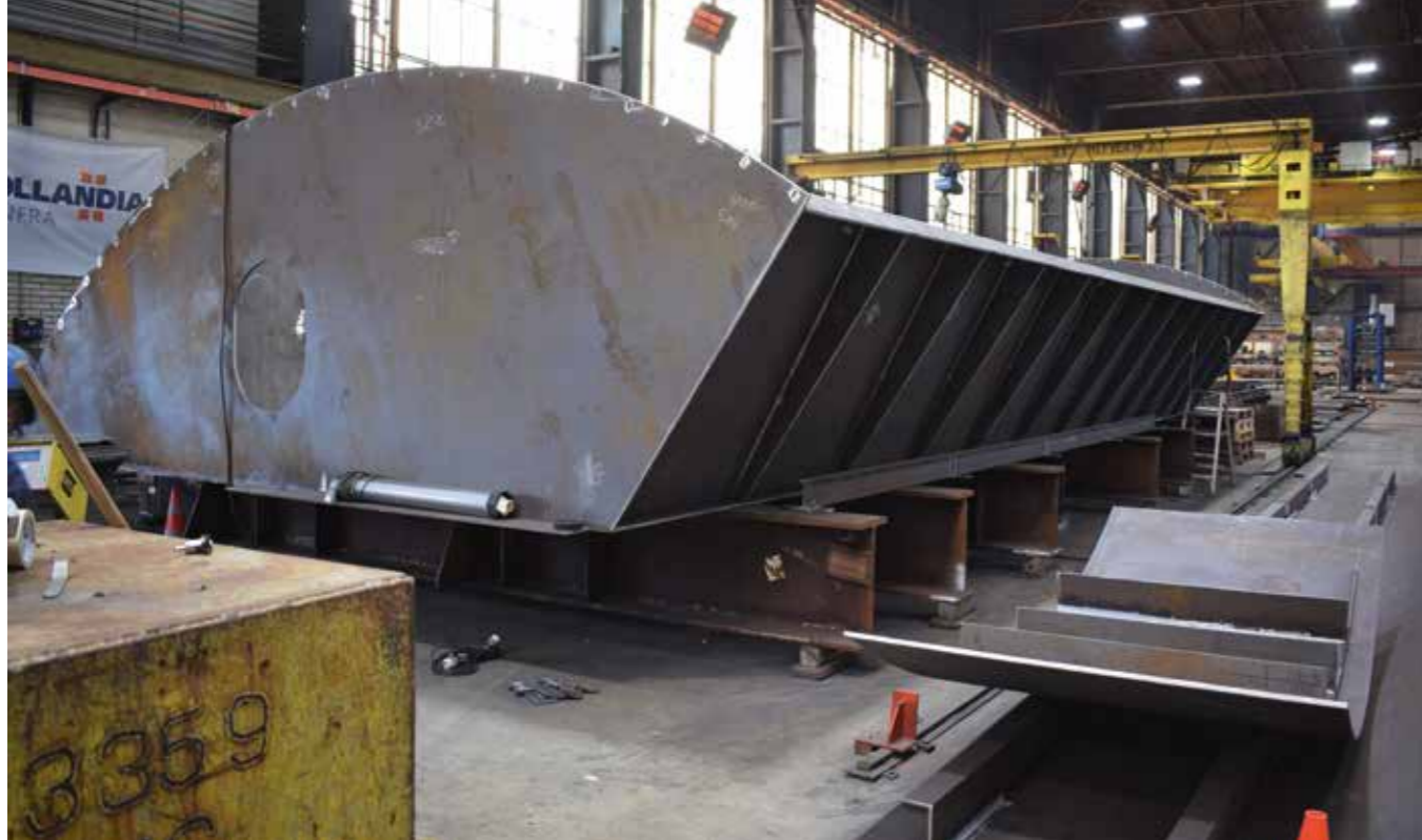
Fabricage van de segmentdeur (foto: Hollandia Infra).
