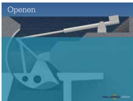
3D-model van de segmentdeur, met onderin de vulschelp waar het water doorheen stroomt als de segmentdeur op een kier staat tijdens de inlaat (foto: Hollandia Infra).
