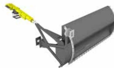
3D-model van de segmentdeur, met onderin de vulschelp waar het water doorheen stroomt als de segmentdeur op een kier staat tijdens de inlaat (foto: Hollandia Infra).
