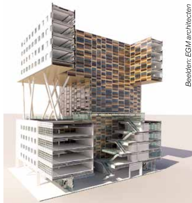
3-Dimensionale doorsnede van het Bouw Informatie Model
